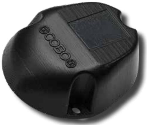
UWR è un dispositivo che consente di ricevere dati da un sensore wireless come ad esempio un WED. Una volta ricevuti, i dati sono esaminati e resi disponibili tramite porta CAN BUS. UWR utilizza una frequenza di 2.4 Ghz, con una identificazione unica del dispositivo a cui è connesso, al fine di assicurare un'alta sicurezza di trasmissione.
